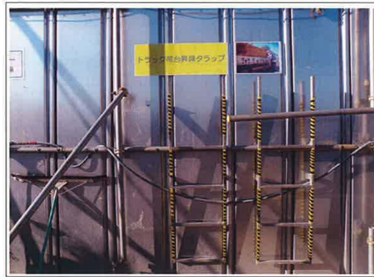
車両の荷台への昇降用タラップです。
