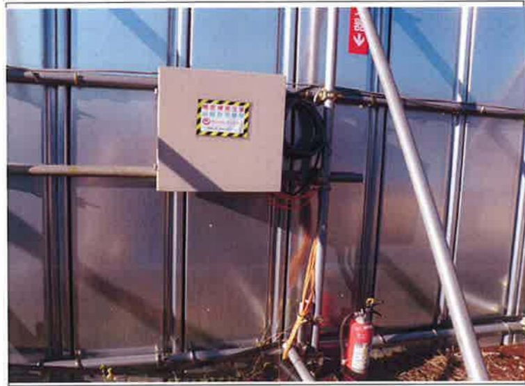
①山留自動計測システムです。 ②精密機械です。衝撃を与えないこと。
