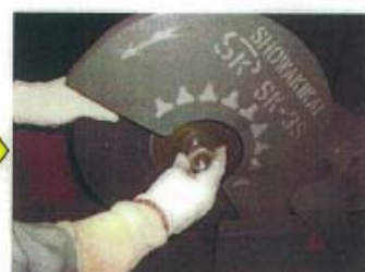
⑧締め付けナットを取付ける。
