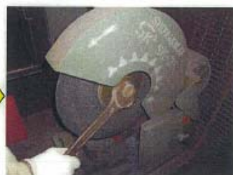
③砥石の締め付けナットを緩める。
