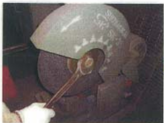
⑨ナットを締め付ける。
