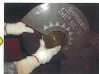
④砥石の固定金具を取外す。
