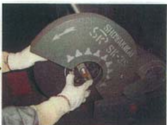
⑥取替砥石を取付ける。
