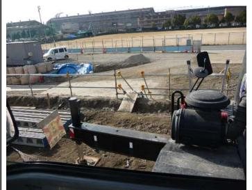
操縦装置及び本体はオペレータ の視角を遮断する
