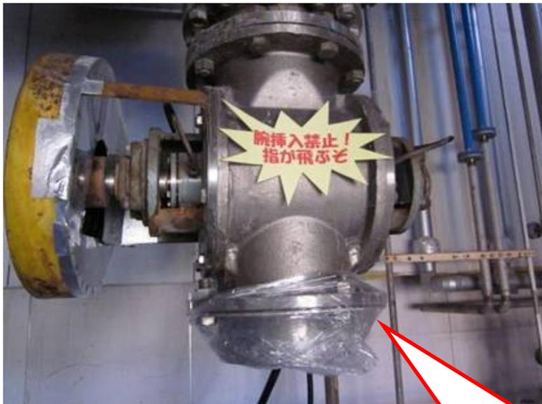
付着物等を除去しようと油断して腕を突っ込むと、ロータリーバルブに巻き込まれ指が切断されてしまう。
