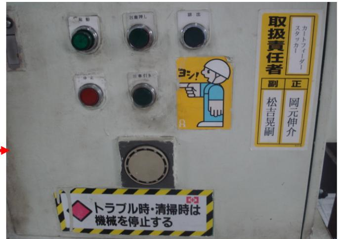
機械の操作盤には取扱責任者を明確にし、メンテナンスやトラブル対応の責任者が見える化しています。指差呼称シールを貼ることで、操作時の指差呼称を意識させています。
