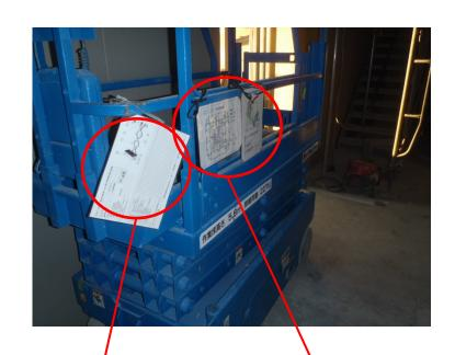
高所作業車の側面に点検表・危険箇所 キープラン・起こりうる過去の高所作業車 の災害事例の掲示(9台それぞれに高所作 業車に異なる災害事例を掲示)
