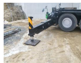
写真-3 事例①積込状況 写真-4 事例④アウトリガー部の沈下
