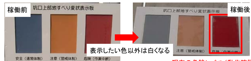
(2) トンネル掘削時の電子ペーパーによる「見える化」
