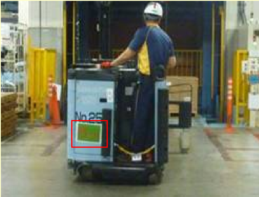
6km制限車の看板を 車両の前後に取付
