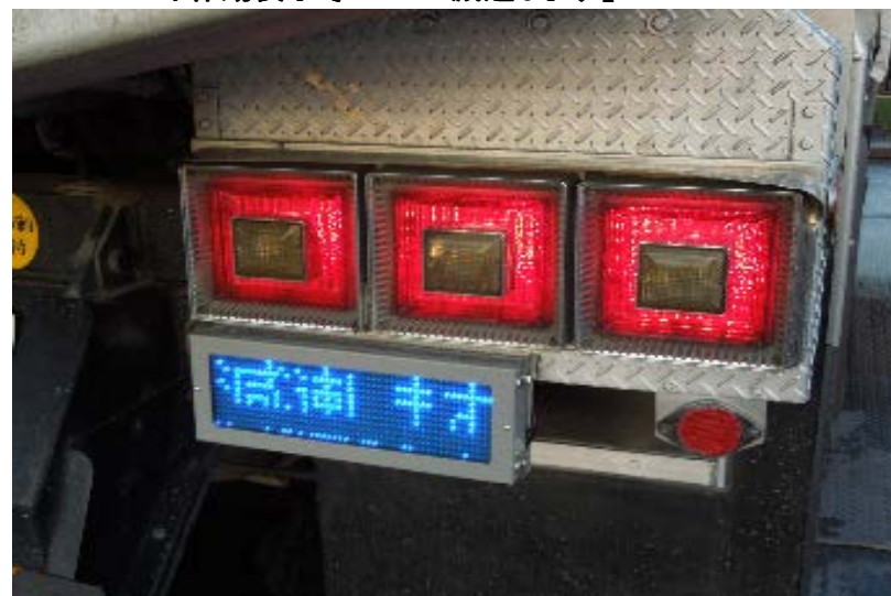
3. ブレーキ作動表示その2:「減速します」
