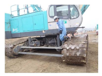
重機昇降時転落防止対策 重機運転席への昇降設備
