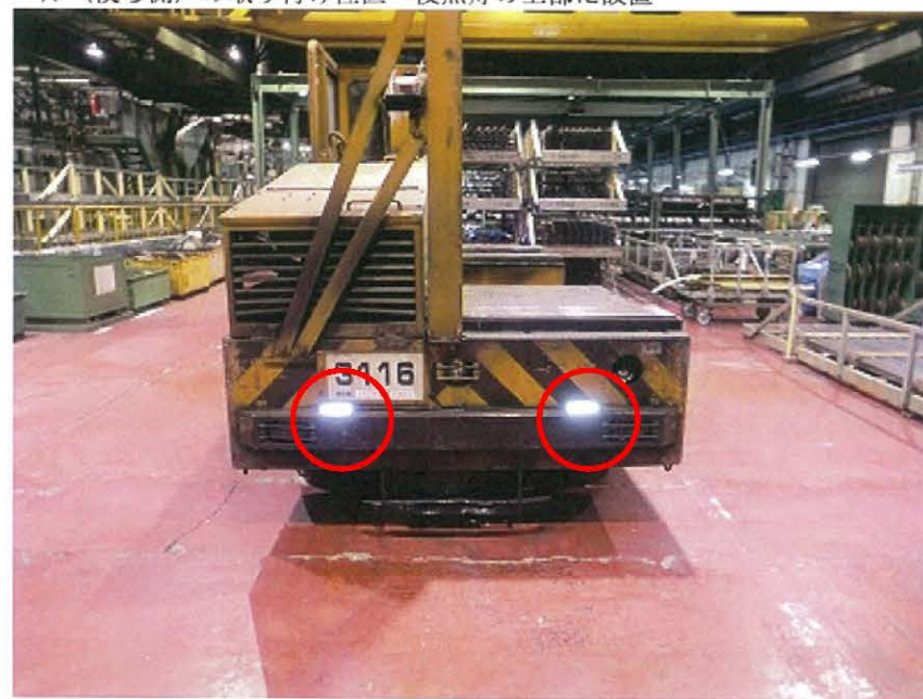
●テール（後ろ側）の取り付け位置→後照灯の上部に設置
