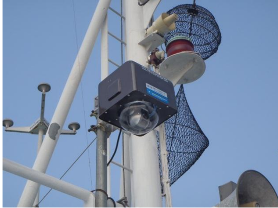
作業船にウェブカメラを設置
