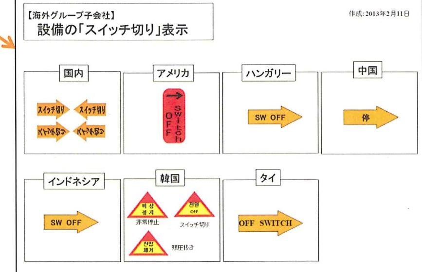
新人でも設備を停止する操作がすぐわかるようにする目的で実施している。
