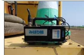
作業員ヘルメットと重機後方にセンサーを取付け、両者が近接(10m以内)するとブザーが鳴り注意喚起する。(音による見える化)
