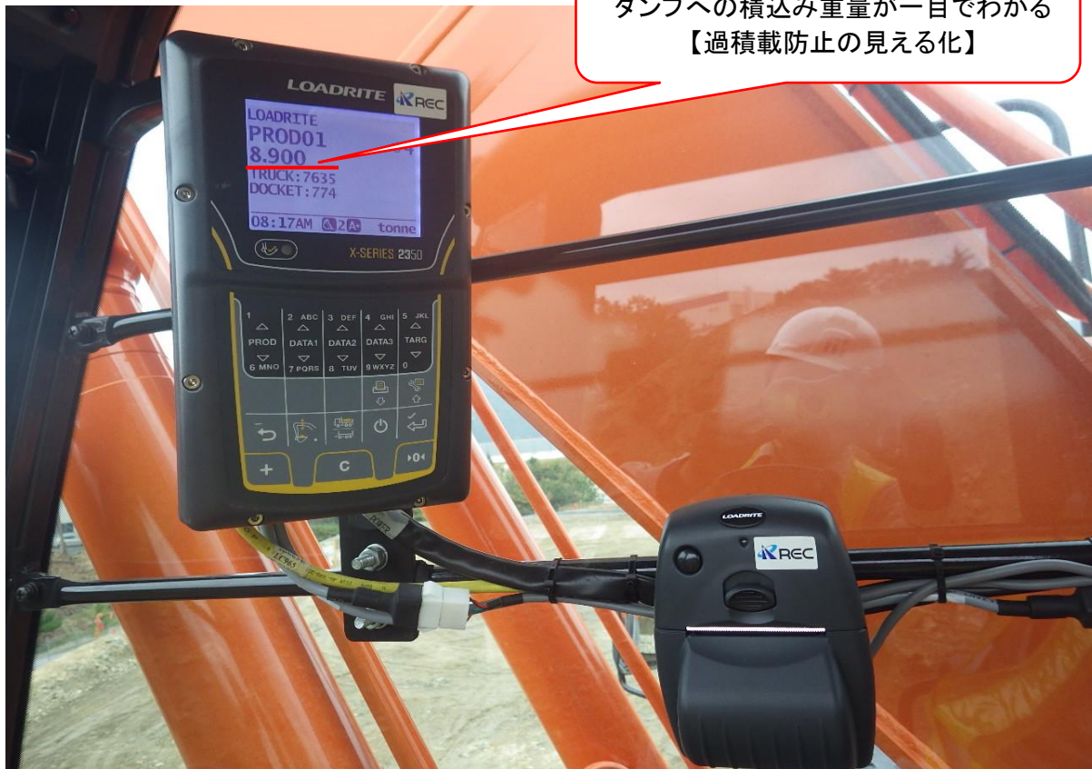
重機内モニター画面
