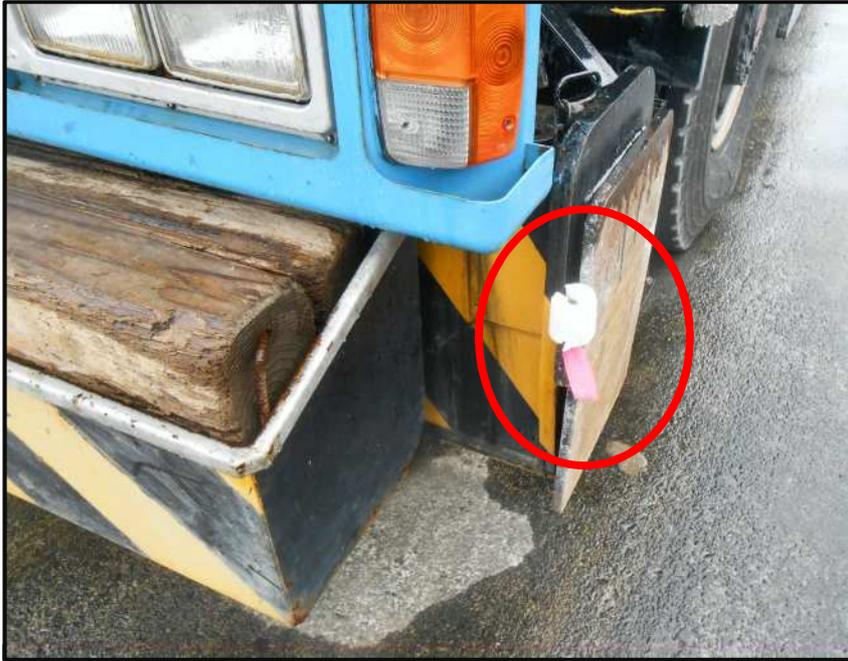
アウトリガーを張り出して作業する機械は、安全通路を近接して設ける場合が多くあります。アウトリガーやミラーにピンクリボンや緩衝材を取り付け、危険物を歩行者に分りやすくする提案です。
