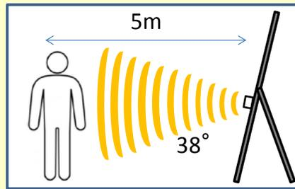
検知エリア内に人が入ると、遠赤外線センサーが作動する
