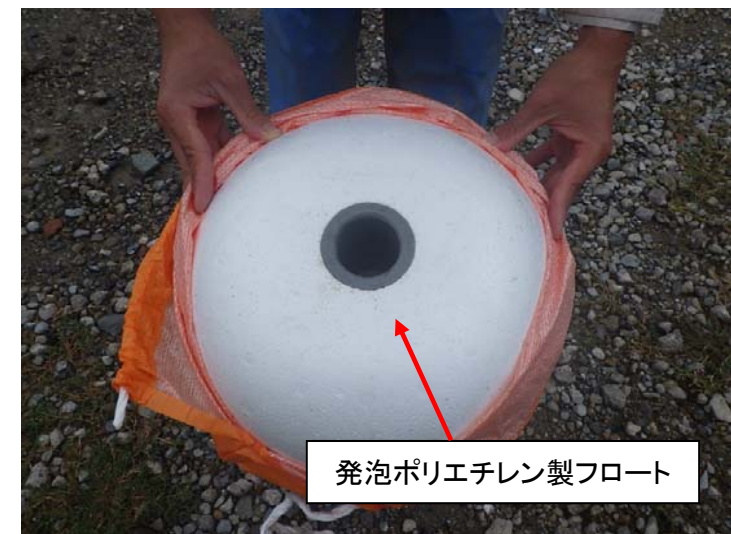
俵杭(スチロバール)材料確認 φ300×L550
