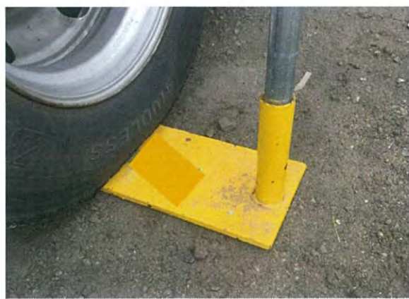
単管差込み式ベースプレート タイヤで踏んで安定させています。
