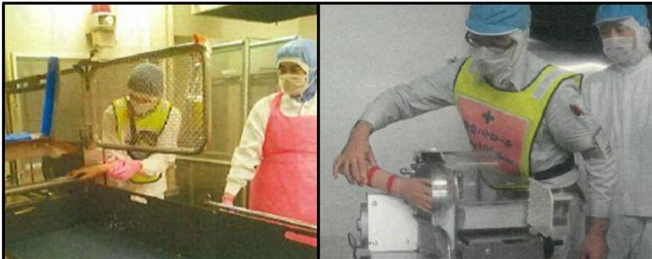
講習時、安全を確保した状態で、実際の機械に義手を挟ませ、義手が切断されることで、義手を通して自分の手が挟まれたことを疑似体験。
