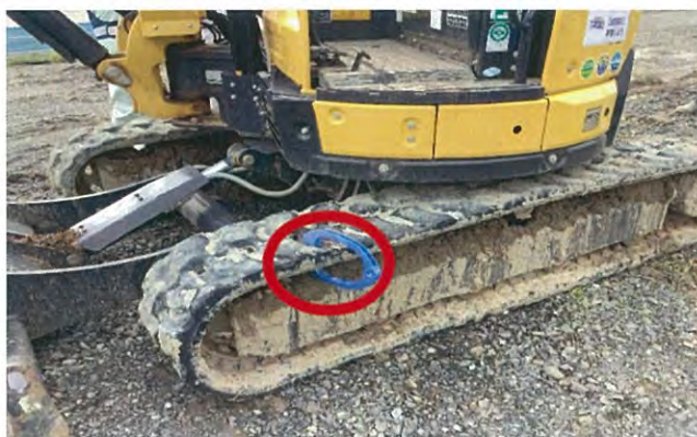
「キャタクリップ」設置状況(左前)
