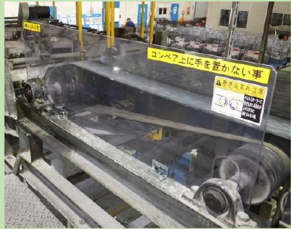
塩ビ板でカバーを作成し、誤って手が入らない様にした。(全長3m以上あるため、5箇所に分けてカバーを設置)
