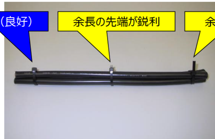
束線バンドの余長切断形状
