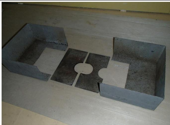
【 溶接時の「スパッタ飛散防止策」 】
