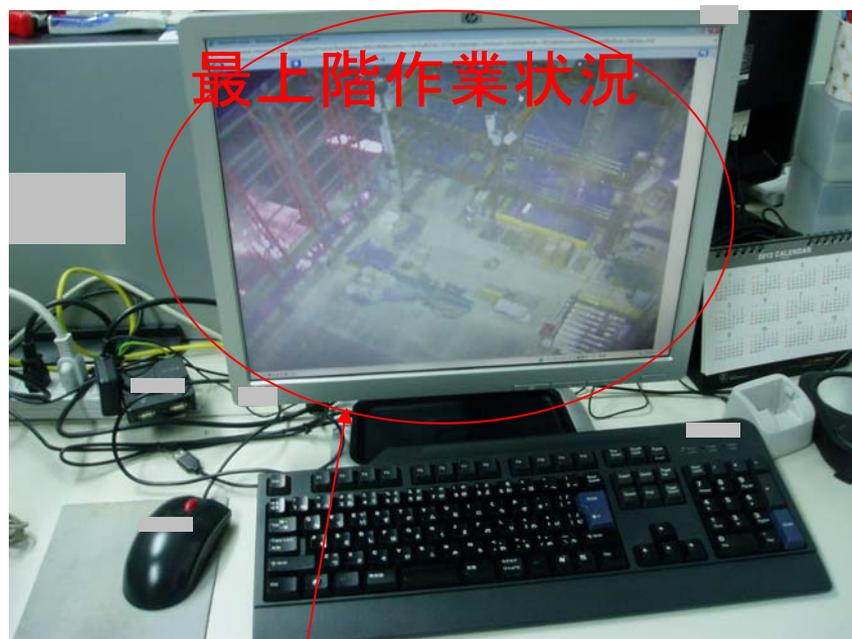
タワークレーンに付けているカメラにて、最上階の作業状況がパソコンにていつでも把握できる。
