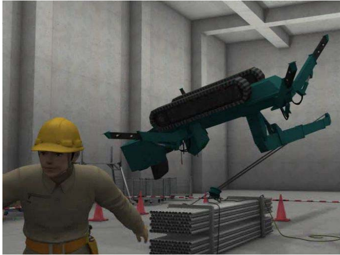
カニクレーン荷重オーバーで落下
