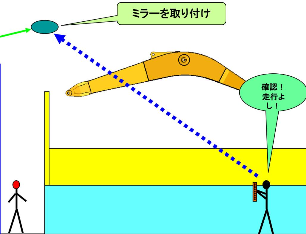
・ 頭上（柱）にミラーを取り付け、クレーン操作時に確認、死角を無くす事が出来た。
