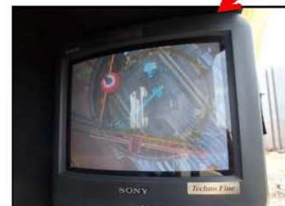
クレーンカメラ モニター
