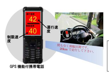
狭隘区間、交差点、車両出入口等 の危険箇所への接近を音声で運 転手に警告する安全ナビゲーションシステム
