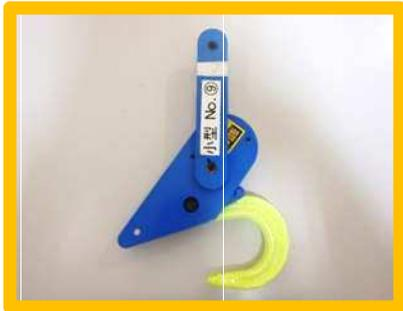
※荷重が抜けると自動で玉外しができる吊具
