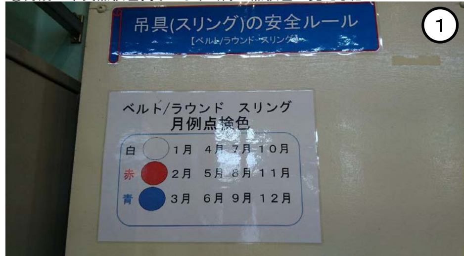
②月別の吊具点検色掲示により当月の点検色の見える化
