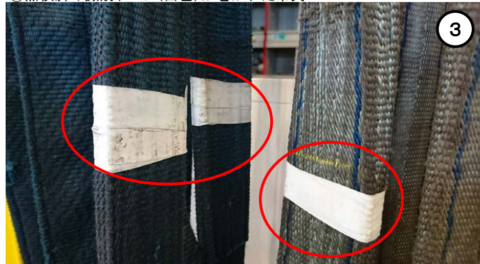
④点検済み識別テープ(白色)が巻かれた吊具
