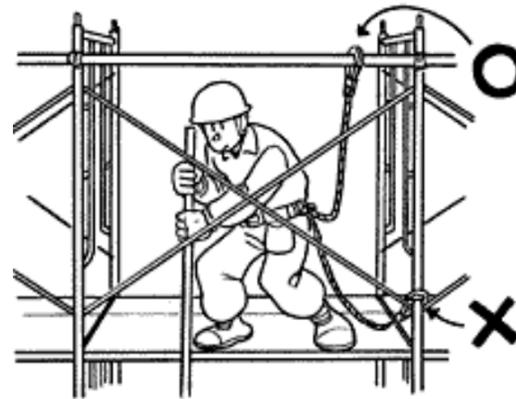
ポイント 2 墜落時の衝撃による背骨による背骨への負担を軽減させるために、D環あるいは巻取り器の位置を身体の横、あるいは斜め後にくるように装着していますか？
