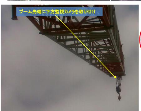
120 + クローラクレーンに ついては、狭い作業帯内での作業 において、吊り荷の玉掛什状況等が運 転席から見えない場合があり、無線及び手 による合図とは別に、スーム先端から下方 を確認するためのカメラを取り付けた。
