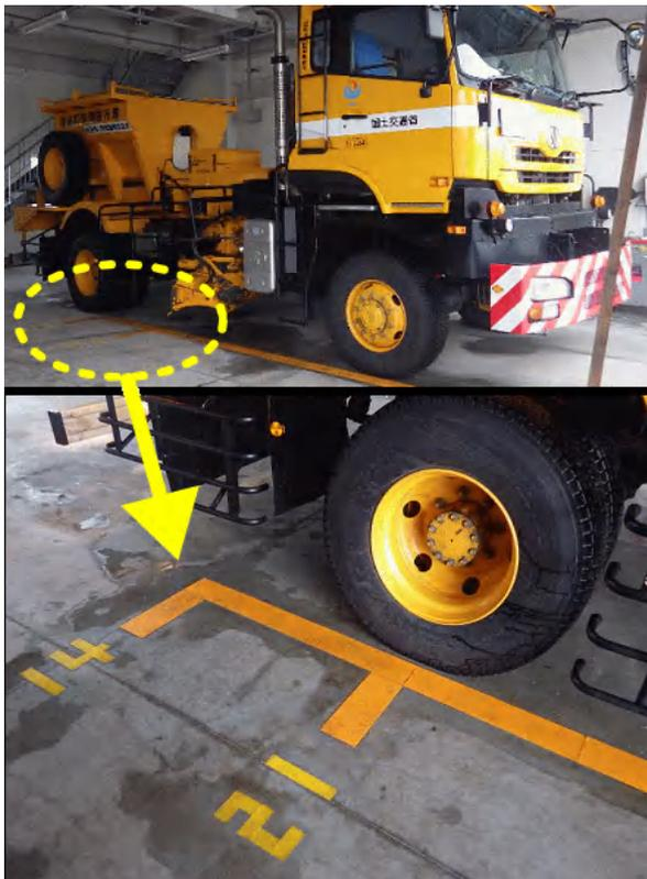
蛍光テープを貼り種類の違う散布車の番号を表示する事で、誘導無しでも規定の位置に散布車を停車することを可能に、助手の昇降時の転倒を低減した。
