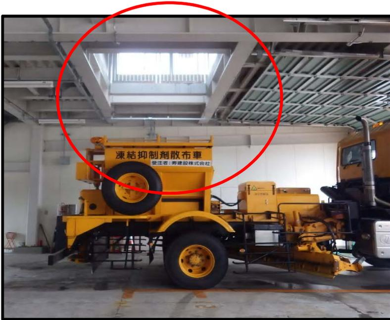
融雪剤（トンパック）を投入するために、散布車を上部開口の位置に止める必要がある。車高の高い散布車から助手が降り散布車の誘導を行っていたがステップに雪が積もっていて、転倒のリスクが高かった。
