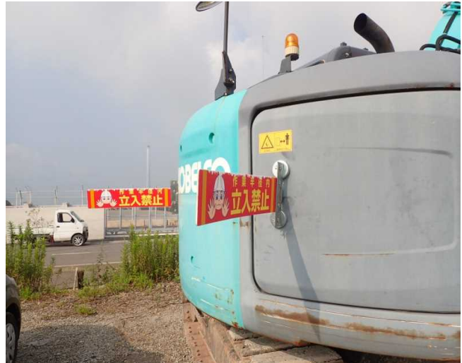
バックホウ旋回体の挟まれ防止対策(エスカルバー)設置使用状況
