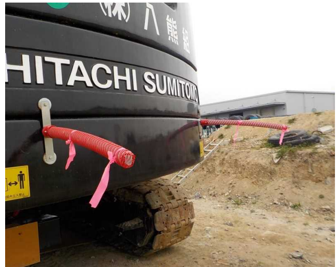
クレーン旋回体の挟まれ防止対策(エスカルバー)設置使用状況
