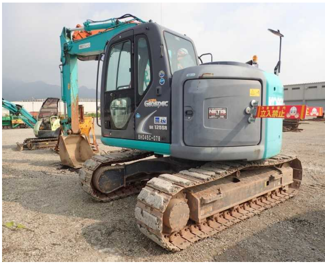
バックホウ旋回体の挟まれ防止対策(エスカルバー)設置使用状況
