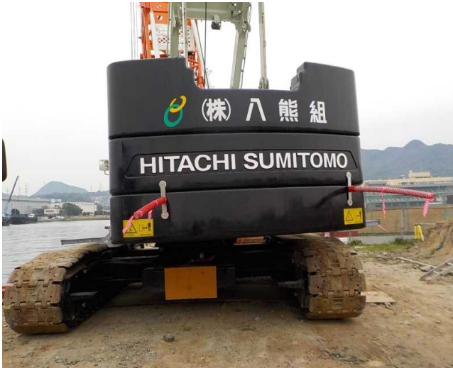
クレーン旋回体の挟まれ防止対策(エスカルバー)設置使用状況
