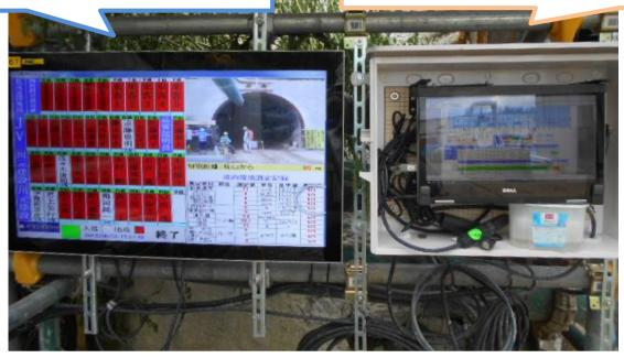
コメント 左モニター: 入坑管理システム 、 右モニター : 先行変位計データ
