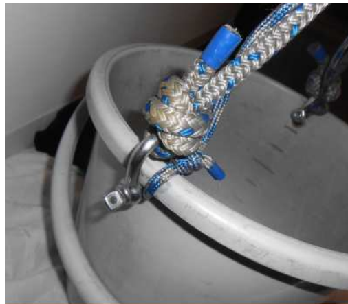
シャックルと綱で補強した部分
