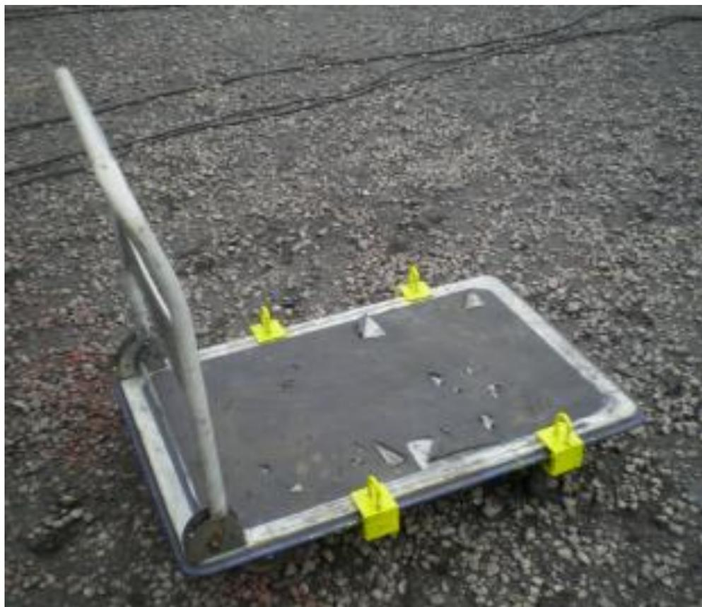
台車運搬時に台車の下を固縛結束具を通す作業は危険を伴いやり難い作業で有り、効率化を図った。
