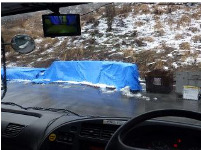
貨物自動車・生コン車車内、ドライブレコーダー・バックモニター設置状況
