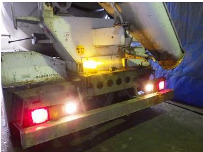
生コン車後進時、バックカメラ・パトライトLED回転灯・バックブザー-作動状況
