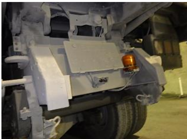
貨物自動車、バックカメラ・パトライトLED回転灯設置状況
