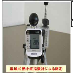
毎日11時~12時の間、「黒球式熱中症指数計」で工場内の主要な作業現場6箇所を測定し、当日の熱中症指数の状況を掲示する事により、熱中症に対する予防および注意喚起を図った。
