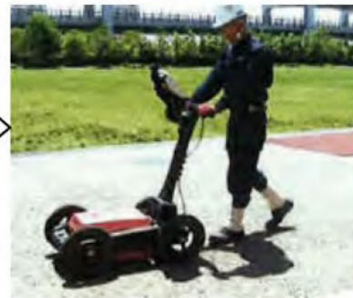
既存埋設配管 レーダー探査
