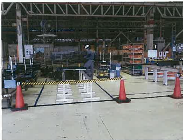
集積作業中はフォークリフトが進入しないようトラテープを張っている
