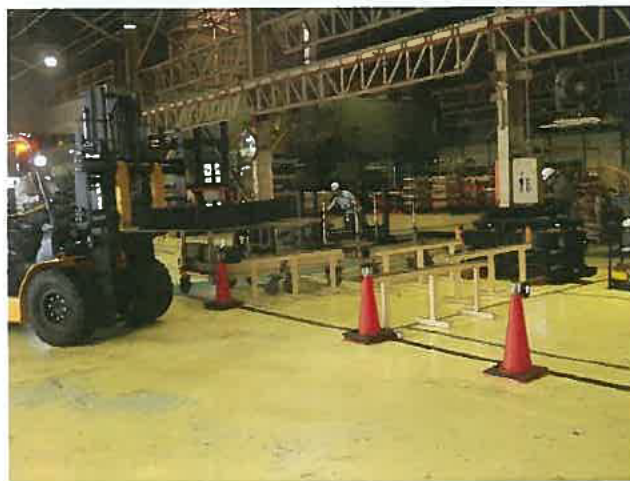
フォークリフトで製品を搬入してよい状態の時はトラテープを格納し フォークリフトオペレーターが分かるようにした
