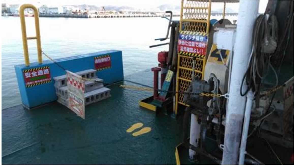
防護柵と操作者位置明示
