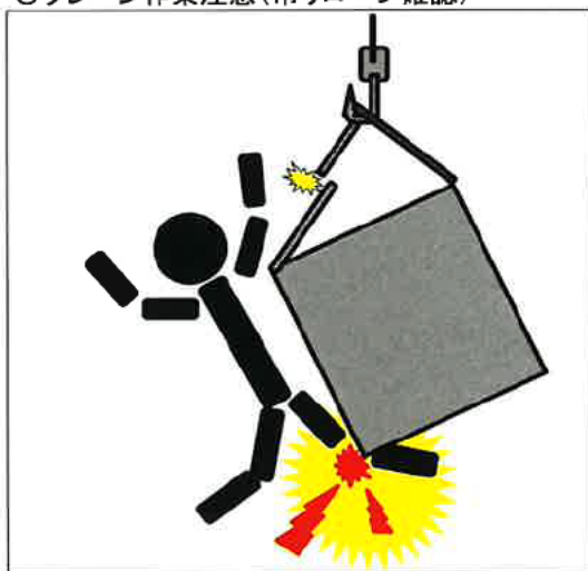
○クレーン作業注意(吊りロープ確認)
