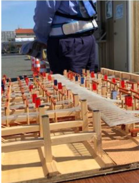
栈橋のスラブ・梁を受ける支保工模型
