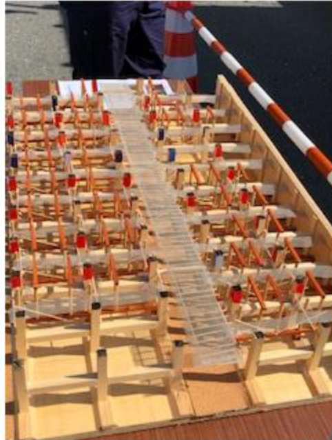
栈橋のスラブ・梁を受ける支保工模型
