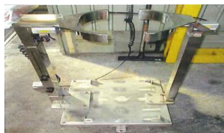
写真③ 治具の口元を切断、クラフト袋が大きく開口する様にした。
