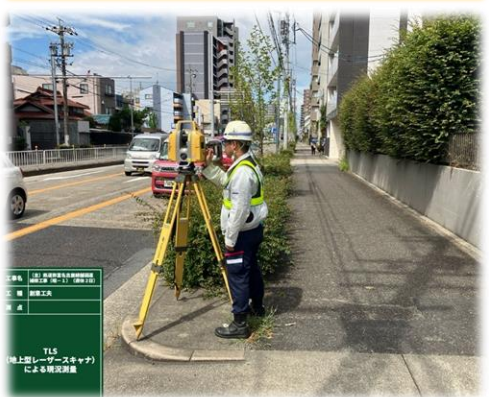
ICT技術を活用した道路規制を伴わない3D測量業務
