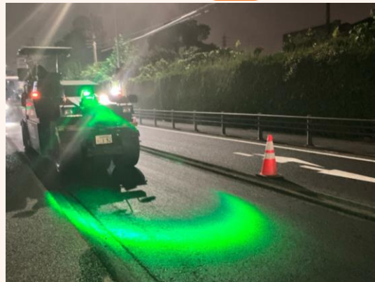
タイヤローラーに取り付け 重機操縦者の視認性UP
